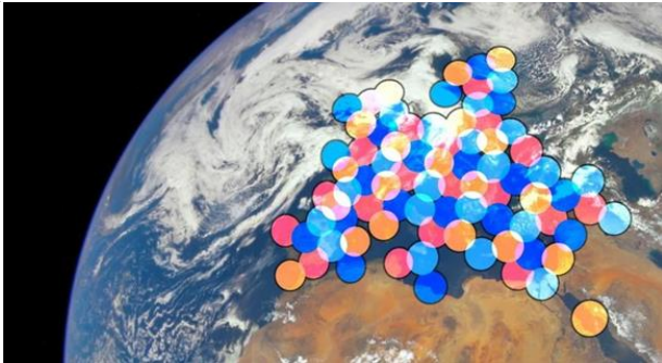
Gambar 3. Ilustrasi Spot Beam pada HTS
